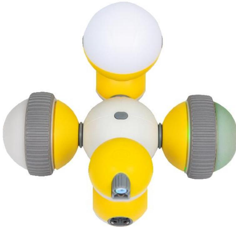
➤ Mabot 前进一段距离，需要设置左轮顺时针转动，右轮逆时针转动；所以将 1 号驱动球速度设置为 30, 2 号驱动球速度设置为-30（负数代表逆时针转动）。
