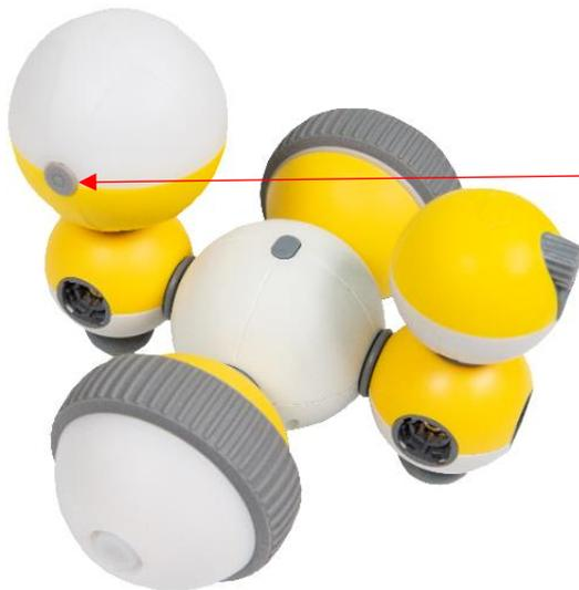
点击主控球上的任意按钮执行已经上传到主控球的程序，再次点击主控球上的按钮停止运行程序
